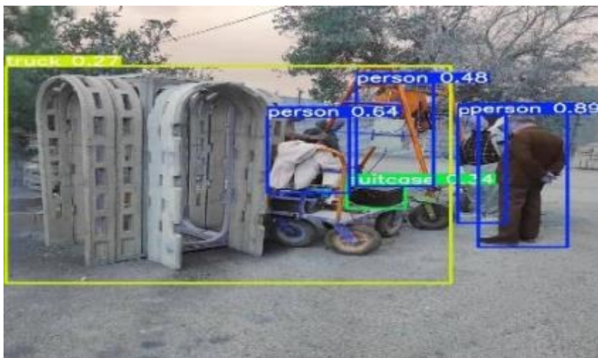
نمونه ای از بکار گیری هوش مصنوعی آفلاین YOLO تشخیص اشیا در سیستم خود حفاظتی بالابر ربات مخصوص قنات
